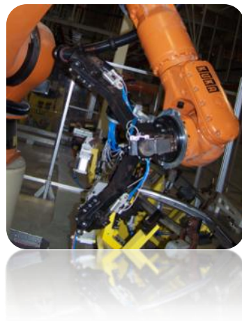
无胎膜滚边工艺上的包边工具 Hemming Head without hemming bed
